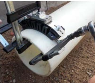
Verarbeitung mittels Aufspannvorrichtung FIXBLOC FWFB
