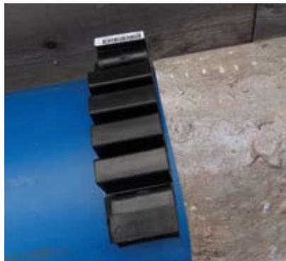
Anwendung Einzugsicherung bei Rohr-sanierung.
