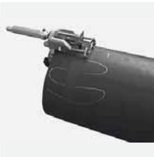
Zum sicheren Entfernen der Oxidschicht von PE-HD- und PE-Xa-Rohren. Schälmesser aus Hartmetall mit zweiter Schneide für doppelte Standzeit (lange Lebensdauer). Gleichmäßiger Spanabtrag durch federgelagertes Schälmesser und automatischen Vorschub. Mit Schnellverstellung zur einfachen Anpassung der Schällänge. Auslieferung in Transportkiste.
