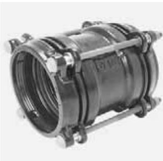
Längskraftschlüssige Kupplung zur Verbindung von PE-HD- (PE80, PE100, PEX/SDR 11, 17 und 17.6) und PVC-Rohren ohne Innenstützhülse. Gehäuse, Druck-, Folge- und Greifring aus duktilem Gusseisen, Korrosionsschutz Rilsan. Schrauben und Muttern aus Edelstahl, verzinkt/theraplexbeschichtet auf Anfrage. Resistors aus Stahl verzinkt. Dichtung EPDM für Trinkwasser.
