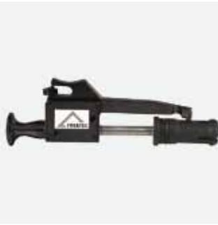
Dimensionsgebundenes Kompaktschälgerät in Metallausführung zum sicheren Entfernen der Oxidschicht von PE-HD- und PE-Xa-Rohren und von Abgangsstutzen an FRIALEN Formstücken. Extralange Schällänge auch für FRIALONG-Langmuffen. Schälmesser aus Hartmetall mit 2 Schneiden (doppelte Lebensdauer). Automatischer Ausgleich von Rohrovalitäten und Toleranzen. Betrieb von Hand, mit Handkurbel oder Akkuschauber.
