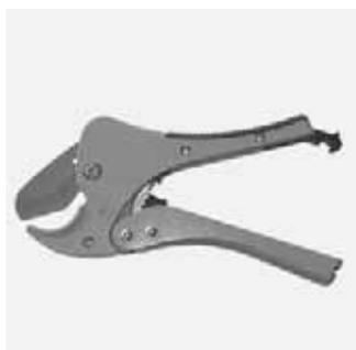
Rohrschere mit Hebelübersetzung für PE-HD-Rohre d 20 bis d 63 in SDR 11.
