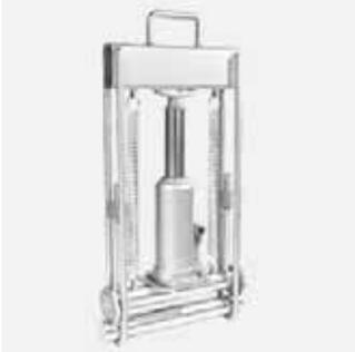
Hydraulische Abquetschvorrichtung zum provisorischen Absperren von PE-HD- und PE-Xa-Rohren d 63 - d 180 in SDR 11 und SDR 17,6.
