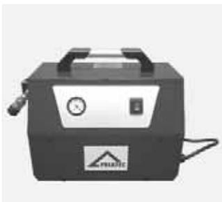
Zur Montage von FRIALEN XL Stutzenschellen SA XL, FRIALEN Reparatursätteln RS XL sowie von FRIAFIT Abwassersätteln ASA VL. Bestehend aus Vakuumpumpe 230V, Manometer und Anschlussleitungen. Kein zusätzlicher Baustellenkompressor zum Betrieb erforderlich. Auslieferung in Transportkiste.
