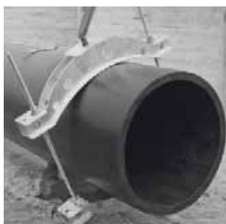
Zum Rückrunden von PE-HD-Rohren. Dimensionsübergreifend einsetzbar für Rohre d 800 – d 1200.
