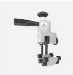
Zum sicheren Entfernen der Oxidschicht von PE-HD- und PE-Xa-Rohren. Schälmesser aus Hartmetall ausgelegt als Wendemesser mit 2 Schneiden (doppelte Lebensdauer). Universelle Schälbereiche, keine Dimensionseinstellung erforderlich. Gleichmäßiger Spanabtrag durch federgelagertes Schälmesser und automatischen Vorschub. Auslieferung in Transportkiste.
