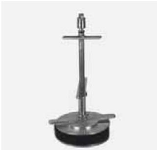
Nennweitenbezogener Presskolben mit Anschlagplatte und Stecknippel NW 7,2 zur Montage auf der FRIALEN XL Stutzenschelle SA XL mit Abgang d 160, d 225 oder d 250 oder auf dem FRIAFIT Abwassersattel ASA VL mit Abgang 225 und zum Anschluss der VACUBOX.
