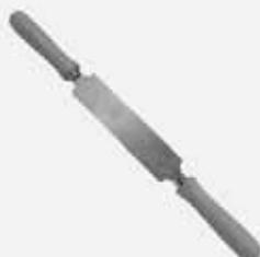
Zum Entfernen der Oxidschicht von PE-Großrohren, die nicht durch entsprechende Schälgeräte bearbeitet werden können. Insbesondere zur Vorbereitung von Sattelflächen für die Verarbeitung von FRIALEN XL Sattelformstücken. Ebenso geeignet zum Entgraten von Schnittkanten. Mit zwei Schneidflächen.
