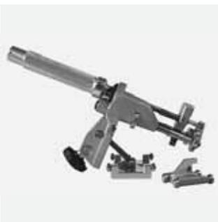
Zum sicheren Entfernen der Oxidschicht von PE-HD- und PE-Xa-Rohren. Schälmesser aus Hartmetall mit zweiter Schneide für doppelte Standzeit (lange Lebensdauer). Gleichmäßiger Spanabtrag durch federgelagertes Schälmesser und automatischen Vorschub. Mit Schnellverstellung zur einfachen Anpassung der Schällänge und wechselbarem Spanschlitten für die Dimensionen d 75-d 225 und d 250-d 400. Auslieferung in Transportkiste.
