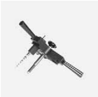
Kombiniertes Aufspann- und Anbohrgerät, universell einsetzbar für FRIAFIT Abwassersättel ASA TL und Übergangssättel ASA TL KG. Zum Aufspannen und Herstellen des notwendigen Fügedrucks bei der Schweißung. Zum Anbohren durch den Abgangsstutzen im drucklosen Zustand nach Ablauf der vorgeschriebenen Abkühlzeit. Auslieferung in Transportkiste.
