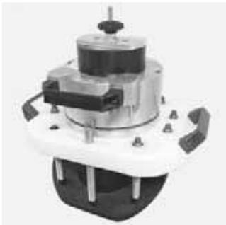
Aufspanngerät zur Verarbeitung von FRIAFIT Abwassersätteln ASA TL und Übergangssätteln ASA TL KG speziell bei PE-HD Close-Fit-Linern DN 200 - DN 500 und bei PE-HD Rohren d 630. Zum Aufspannen und Herstellen des notwendigen Fügedrucks bei der Schweißung. Bestehend aus ASATOP Spanngerät mit Kippdübel (ohne rohrumfassende Spanngurtechnik), Lochsäge (Ø 95 mm) mit SDS-Lochsägenaufnahme, Zentrierbohrer und Verlängerung sowie Druckluftpumpe. Auslieferung in Transportkiste.
