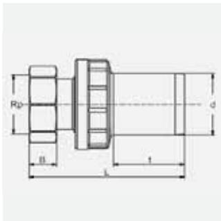
Übergangsadapter mit frei drehbarer Überwurfmutter, zur einfachen und schnellen Montage auf ein feststehendes Außengewinde. Zum Einsatz im Wasserbereich. PE-Rohrstutzen SDR11. Länge des Abgangsstutzens für FRIALONG Muffen nicht geeignet.
