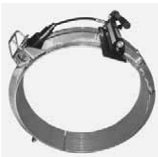
Zum Rückrunden von PE-HD- und PE-Xa-Rohren.
