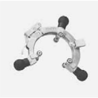
Dimensionsgebundenes Schälgerät zum sicheren Entfernen der Oxidschicht von PE-HD- und PE-Xa-Rohrenden und im Sattelflächenbereich. Schälmesser ausgelegt als Wendemesser mit 2 Schneiden (hohe Lebensdauer). Einfaches Aufspannen durch offene Bauweise des Schälgeräts. Auslieferung in Transportkiste.
