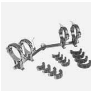
Rohrhalteklemme mit Winkelverstellung (45° / 90°) und 2 Spannelementen für Heizwendelschweißmuffen, Reduktionen und Winkel 45° und 90° in d 63, d 90, d 125 und d 180. Abdeckung mehrerer Dimensionen durch Einsetzen von Reduzierhalbschalen. Auslieferung in praktischer Tragetasche.
