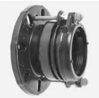
Längskraftschlüssiger Flanschadapter zur Anbindung an PE-HD- (PE80, PE100, PEX/SDR 11, 17 und 17.6) und PVC-Rohre ohne Innenstützhülse. Gehäuse, Druck-, Folge- und Greifring aus duktilem Gusseisen, Korrosionsschutz Rilsan. Schrauben und Muttern sind verzinkt/theraplexbeschichtet bzw. in Edelstahl lieferbar. Resistors d 63 - d 315 aus Stahl verzinkt. Dichtung EPDM für Trinkwasser. Flanschanschluss nach EN 1092, PN 10/16 (vgl. Tabelle Flanschanschlussmaße).
