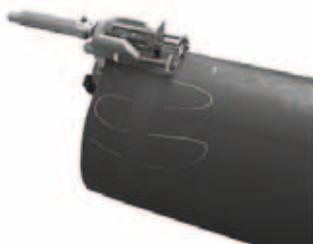
Dimensionsübergreifendes Schälgerät FWSG 225
