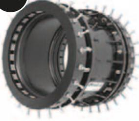
Längskraftschlüssige Reduzierkupplung zur Anbindung von Rohren unterschiedlicher Materialien (Stahl, Grauguss, Duktillguss, Asbestzement, PVC, PE-HD/PEX) im Tiefbau.
