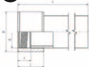
Muffe mit einseitig eingeschweißtem PE 100-RC, Typ 2
