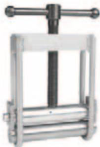
Manuelle Abquetschvorrichtung SQM zum provisorischen Absperrern von PE-HD- und PE-Xa-Rohren d 63 - d 125 in SDR 11 und SDR 17,6.
