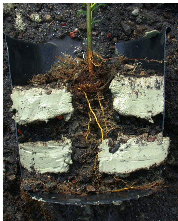
Abb. 7: Geöffnetes Pflanzgefäß, Wurzeln mit Wasser freigespült. Die Wurzeln sind nicht in das Bentonit gewachsen.
