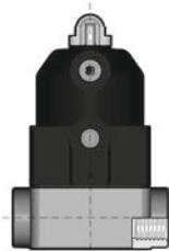
2/2-Wege-Membranventil mit pneumatischem Stellantrieb und optischer Stellungsanzeige
