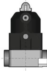
2/2-Wege-Membranventil mit pneumatischem Stellantrieb und optischer Stellungsanzeige
