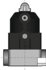
2/2-Wege-Membranventil mit pneumatischem Stellantrieb und optischer Stellungsanzeige
