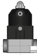
2/2-Wege-Membranventil mit pneumatischem Stellantrieb und optischer Stellungsanzeige
