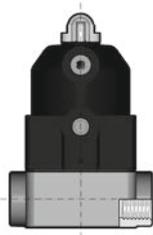
2/2-Wege-Membranventil mit pneumatischem Stellantrieb und optischer Stellungsanzeige
