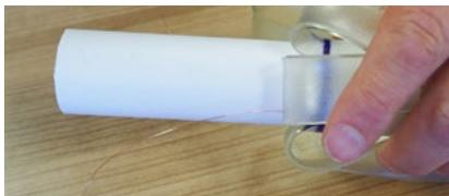
Stellen Sie sicher, dass der Kupferdraht noch intakt und nicht beschädigt wurde. Das Innenrohr bleibt unbeschädigt.
