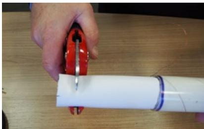
Schneiden Sie das Ende des Rohrs an der Stelle, an der Sie es durchgeschnitten haben, vorsichtig ab, um sicherzustellen, dass das Ende des Rohrs nicht beschädigt ist.
