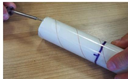
Heben Sie das Ende der äußeren PU-Hülle mit einem kleinen Schraubendreher an.
