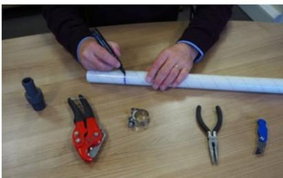
Zeichnen Sie eine Linie, über die doppelte Länge der Einstecktiefe des Fittings. Markieren Sie 4 Punkte rund um das Rohr, an denen Sie es einkerben werden.
