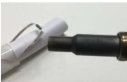
Erhitzen Sie die Hülsen, bis sie vollständig geschrumpft und die Lötringe umschlossen sind. Halten Sie die Wärmequelle in Bewegung, um ein Verkohlen zu vermeiden. Bewegen Sie die Verbindung nicht, bevor sie abgekühlt ist, da dies die Verbindung schwächen kann.
