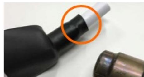
Überprüfen Sie den sichtbaren Klebstoff an der Verbindungsstelle von Schlauch und Rohr. Dieser kleine Wulst aus herausstehendem Klebstoff bildet die Dichtung. Vollständig abkühlen lassen.
