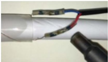
Erhitzen Sie die Löthülsen, bis sie vollständig geschmolzen und die Löttringe umschlossen sind. Halten Sie die Wärmequelle in Bewegung, um ein Verkohlen zu vermeiden. Bewegen Sie die Verbindung nicht, bevor sie abgekühlt ist, da dies die Verbindung schwächen kann.
