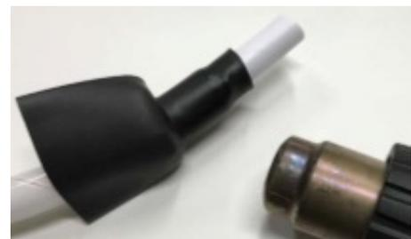
Erhitzen Sie den Schrumpfschlauch, bis dieser vollständig geschrumpft und glatt ist. Halten Sie die Wärmequelle in Bewegung, um ein Verkohlen zu vermeiden.
