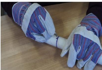
Ritzen Sie die äußere PU-Hülle mit einem scharfen Teppichmesser etwa 0,5 mm tief ein. (Die Beschädigung des Innenrohrs ist zu vermeiden). Verlängern Sie den Schnitt bis zur Markierung (ca. 10 mm). Wiederholen Sie dies bei jeder Markierung.
