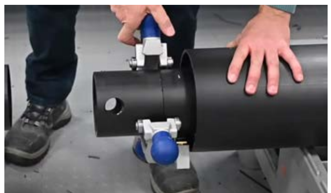
Bild 7: Rotationsschälgeräte vom Typ FWSG SE mit Schäladapter
