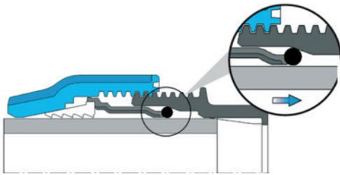
Beim Anziehen der Überwurfmutter wird erst die Dichtung über den Druckring im Gehäuse positioniert.
