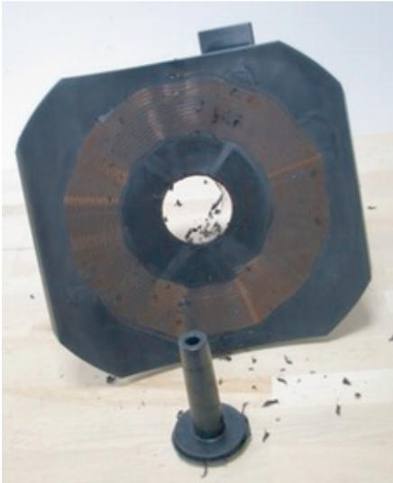
Sattel mit Spitzende Universal SA UNI mit herausgebohrtem Prüfanschluss. Entgraten Sie die Schnittkante an der Sattelfläche (z.B. mit einem Handschauber).
