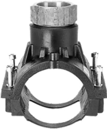
Die Ventilanbohrarmatur VAM RG dient zur Aufnahme handelsüblicher Messingventile. Sie wird nach der jeweiligen Montageanleitung der unterschiedlichen Ventilhersteller mit einem entsprechendem Schleusengerät angebohrt, bzw. mit einem Ventil montiert. Die Vorbereitung und Durchführung einer Druckprüfung erfolgt nach den Angaben der Ventilhersteller.
