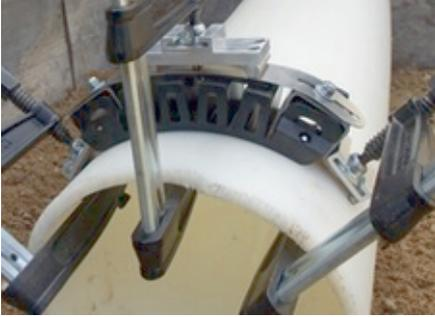
Durch Drehen der Griffe mit einer Ratsche oder einem Schraubenschlüssel wird der FIXBLOC an die Rohroberfläche spaltfrei angelegt.
