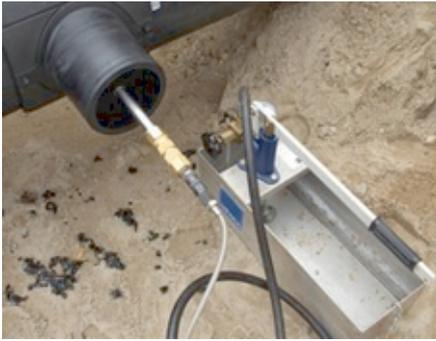
Verbinden Sie den Druckprobenadapter FWOPA SA mit einer Druck-Prüfeinrichtung, z.B. mit einer Handpumpe. Um den Prüfdruck kontrollieren zu können, ist ein Manometer unbedingt erforderlich.
