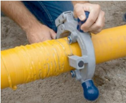
**Abb. oben:** Oxidschichtentfernung am Rohrende mit FWSG Schälgerät
