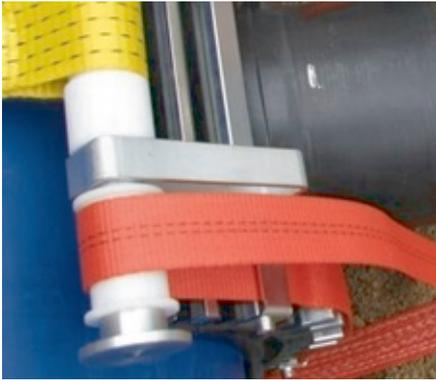
Obere (rote oder blaue) Spanngurte (2) nach Dimensionsbereich (siehe Tabelle unten) auswählen und beide Spanngurte an den Aufnahmepunkten der Spannbalken der Spannplatte (1) einfädeln.
