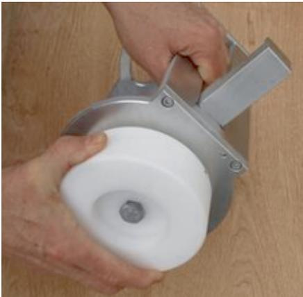
Wählen Sie den passenden Adapter (5) für den Abgangsstutzen der SA UNI (d 90, d 110, d 125 und d 160) aus und schrauben Sie den Adapter an der Spanneinheit (3) fest.
