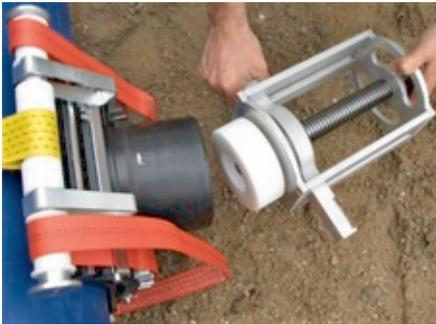
Hierfür wird der Adapter, der auf der Spanneinheit aufgeschraubt ist, in den Abgangsstutzen der SA UNI eingeschoben.
