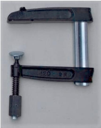
Achten Sie bei der Montage der äußeren Schraubzwingen auf einen größtmöglichen Hub (max. Spannweite der Spannarme) der Gewindespindel. Dies gewährleistet, dass auch größere Spalte zwischen FIXBLOC und Rohr überbrückt werden können.
