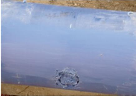
PE-Rohre können punktuelle Rohrbeschädigungen, z. B. verursacht durch Transport, versehentliches Anbohren, Baggereingriff, usw., aufweisen.
