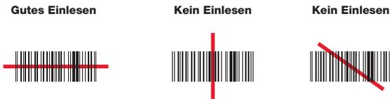
Bei schlecht gedruckten oder leicht beschädigten Barcodes kann es hilfreich sein, den Barcodescanner direkt auf den Barcode zu positionieren um dann - mit gedrücktem Einleseknopf - vom Barcode wegzuführen. Das erfolgreiche Einlesen des Strichcodes wird durch das Ertönen eines Signaltons und das Aufleuchten eines grünen Signallichts in der Mitte des eingelesenen Barcodes signalisiert.
