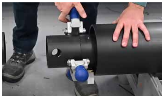
Bild 7: Rotationsschälgeräte vom Typ FWSG SE mit Schäladapter
